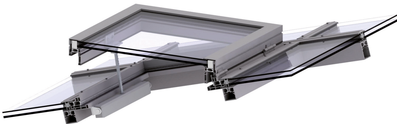
Hoja de ventilador CI-System M en posición de ventilación
